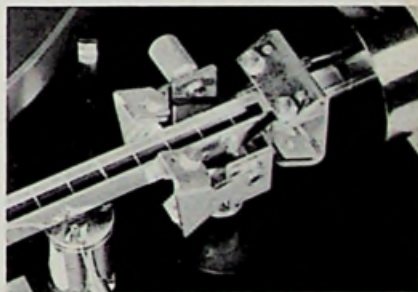
De arm van de ERA 444 is verticaal gelagerd d.m.v. vier kruislings geplaatste bladveren
